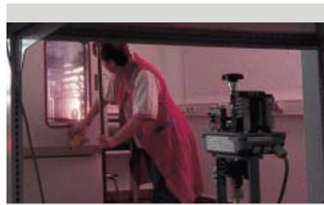
Механическая часть и электронное оборудование исполнительных механизмов, разрабатываемых в нашей компании, подвергается сотням тысяч рабочих циклов в лаборатории усталостных испытаний. В лаборатории имеется "климатическая камера", в которой моделируются предельные температуры и другие состояния окружающей среды, имеется оборудование для измерения действующих сил и крутящих моментов, а также программируемые системы ЦПУ для проверки контрольных образцов по всем возможным диаграммам нагрузки.
