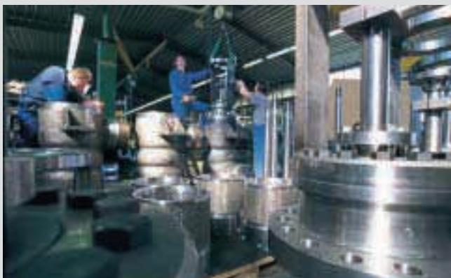
Сборка и испытания промышленных клапанов, которые весят тонны, требует точности до миллиметра – как для этих восьми перепускных клапанов турбины для электростанции в Индии. Сложные функциональные испытания и окончательные приемочные испытания, длившиеся несколько дней, ставили перед монтажным персоналом все новые и новые задачи.
